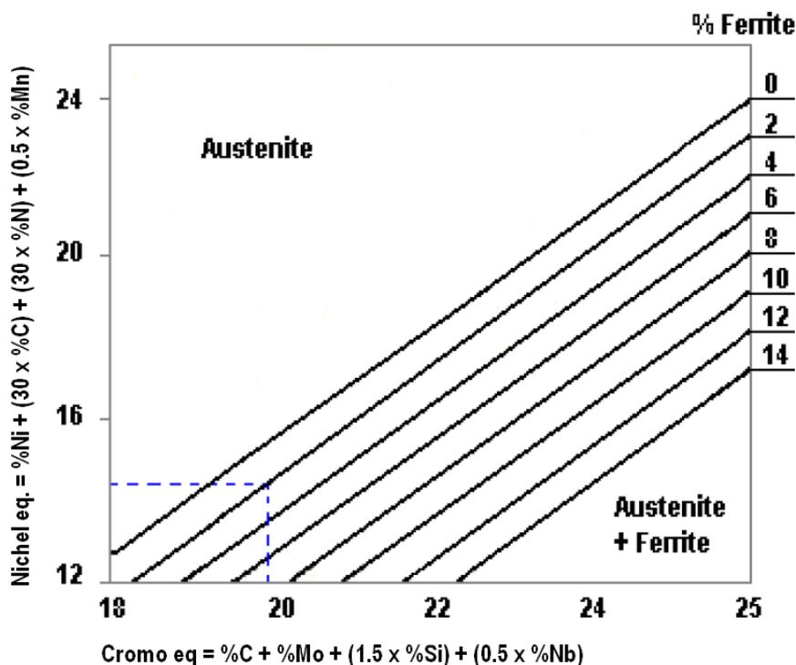
Un attento studio dell'analisi chimica è il modo migliore per prevenire la presenza della ferrite  $\delta$  (delta) nel prodotto finito. Come si può notare dal grafico taluni elementi portati al massimo o al minimo delle forcelle di analisi fissate per l'acciaio scelto possono agire modificando i valori di Ni equivalente e Cr equivalente.
