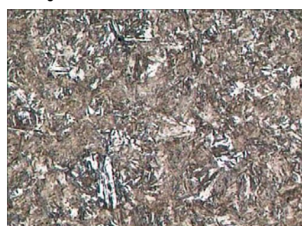
Materiale temprato Struttura: martensite e isole di bainite
