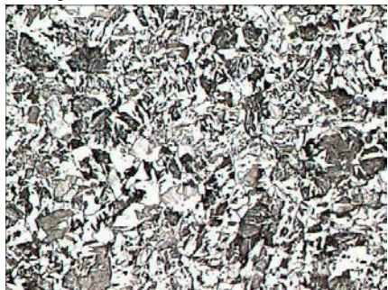
Materiale allo stato naturale Struttura: ferrite, sorbite e bainite
