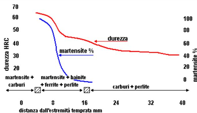
Curve durezza struttura
