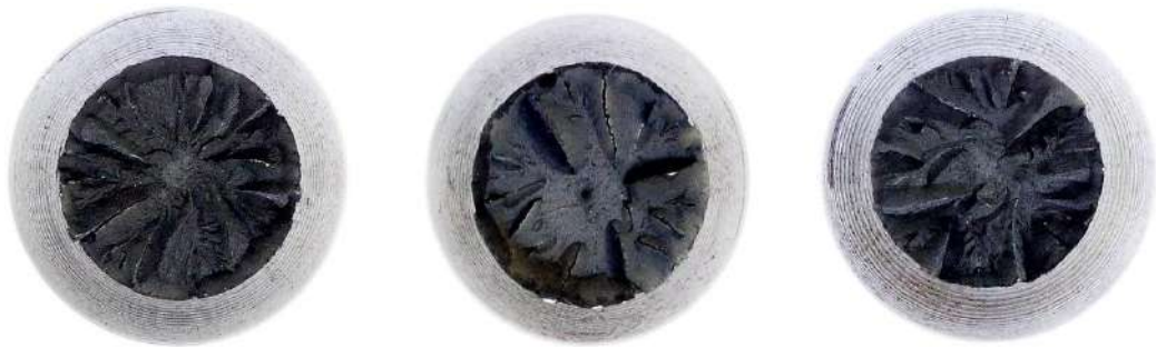
Figura 5.30 Superfici di frattura campioni 1T,5T e 9T.
