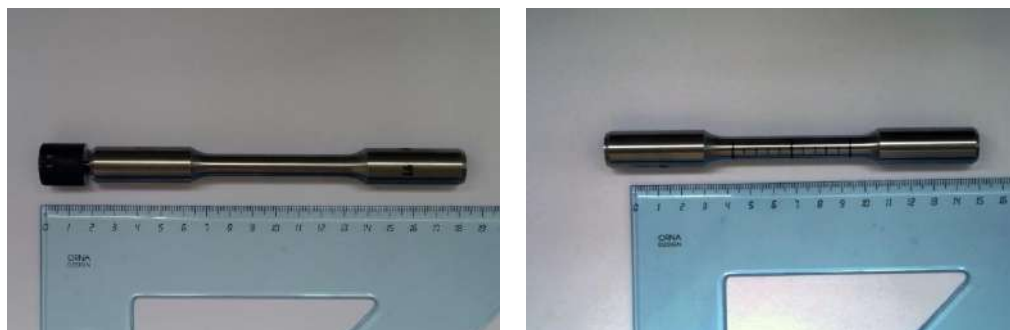
Figura 5.4 Provino di trazione con e senza testimone di lavorazione.
