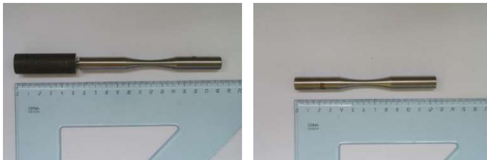
Figura 5.10 Provino di fatica a flessione rotante con e senza testimone di lavorazione.
