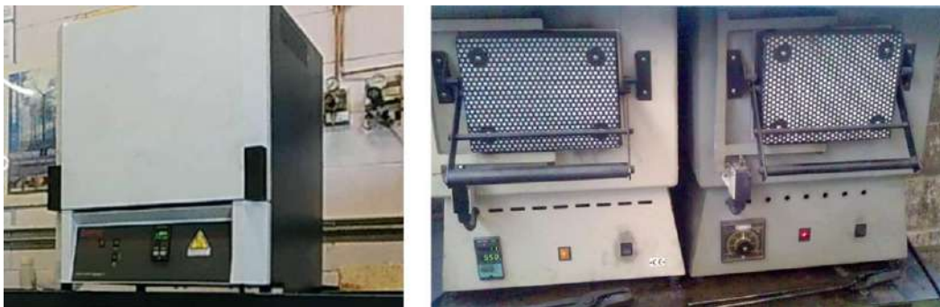
Figura 5.1 Forni utilizzati per i trattamenti termici di tempra e rinvenimento.
