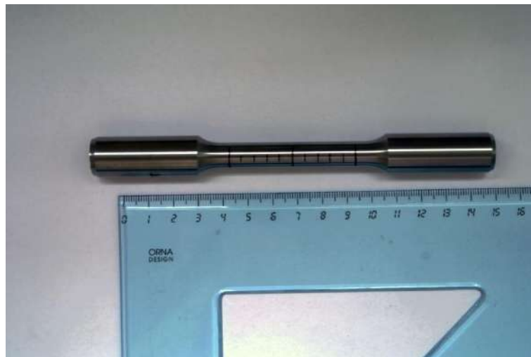
Figura 5.11 Provino di trazione con i riferimenti.
