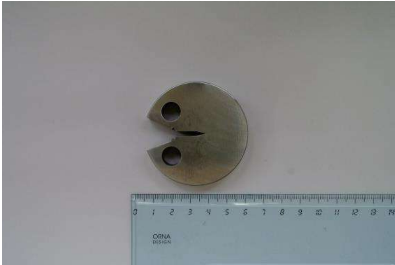
Figura 5.8 Provino di meccanica della frattura.
